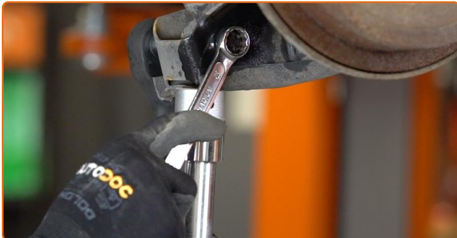
Destornille la fijación inferior del amortizador. Use un vaso de impacto del n.º 16. Usa una llave mixta del n.º 16. Utilice una llave de trinquete.
