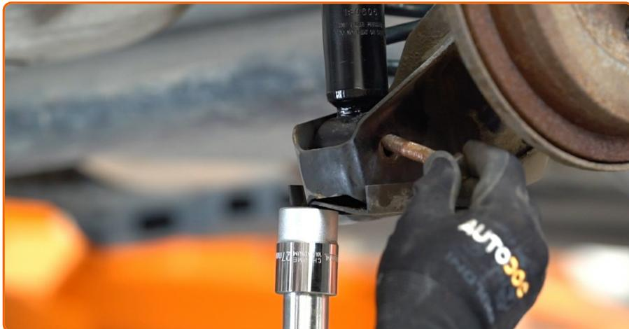
Apuntale la barra trasera del puente. Utilice un gato de transmisión hidráulica.
