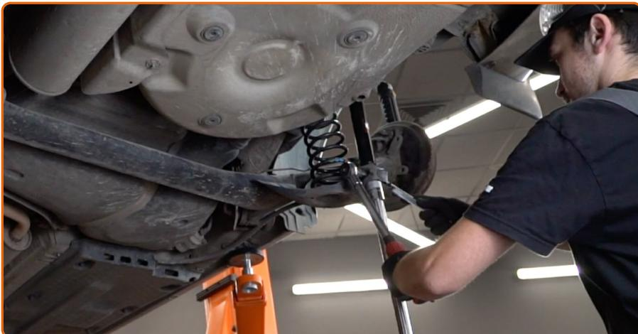
Apriete la fijación inferior del amortiguador. Use un vaso de impacto del n.º 16. Usa una llave mixta del n.º 16. Utilice una llave dinamométrica. Apriételo a un par de 70 Nm.
