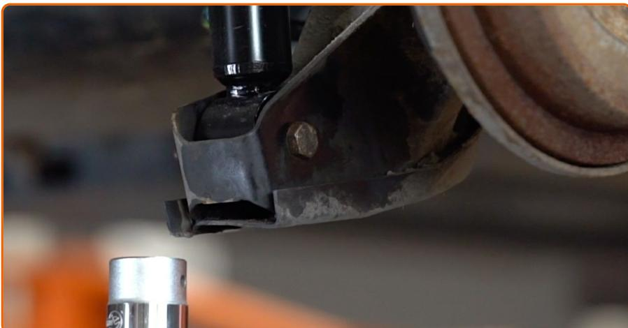
Retire el soporte por debajo de la viga trasera.
