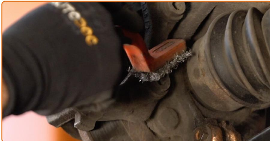
Limpie las sujetaciones del soporte de la pinza del freno. Use un cepillo de alambre. Use el aerosol WD-40.
