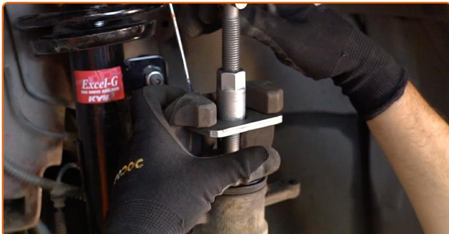
Empuje hundiendo el cáliper de freno. Utilice la herramienta de retorno del pistón de freno.
