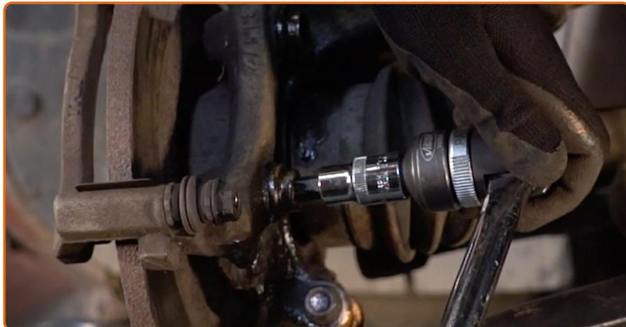
Destornille la fijación de la pinza del cálibre de freno. Utilice Torx T55. Utilice una llave giramachos.
