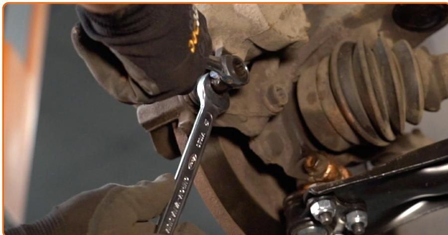
Destornille la fijación del cálibre de freno. Usa una llave mixta del n.º 13. Usa una llave mixta del n.º 15.
