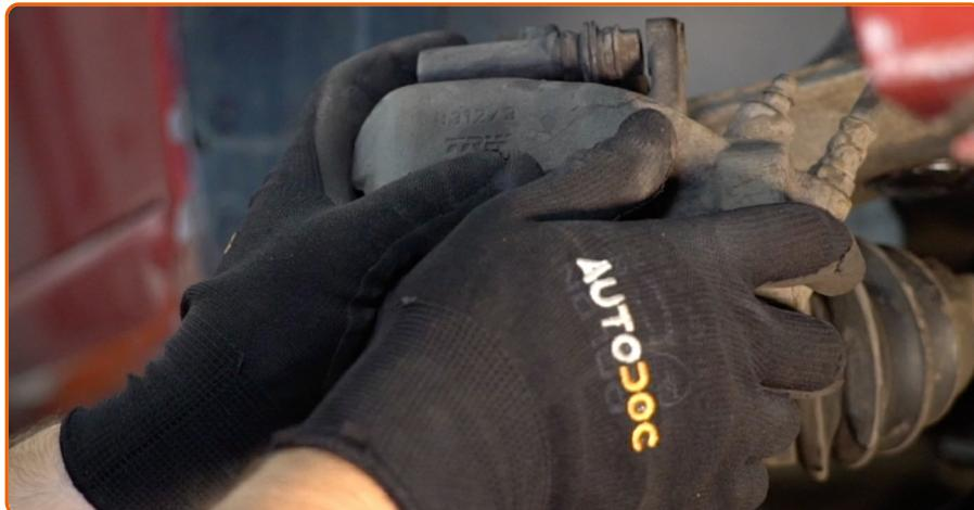
Establezcan el soporte de freno y lo fijen. Usa una llave mixta del n.º 13. Usa una llave mixta del n.º 15. Utilice una llave dinamométrica. Apriételo a un par de 35 Nm.
