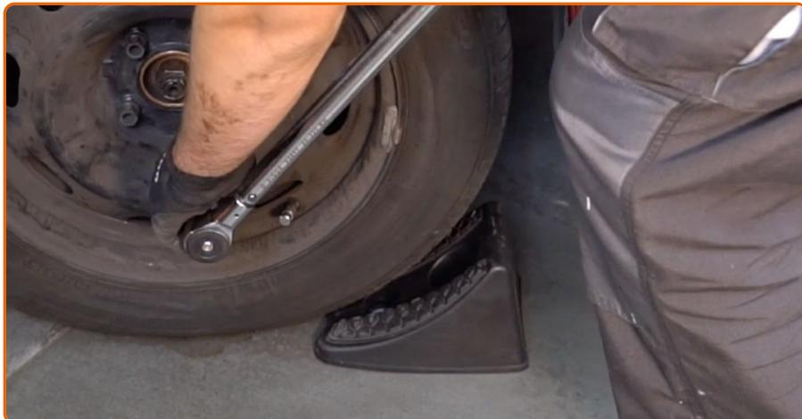
Baje el automóvil y, manteniendo el orden cruzado, apriete los pernos de fijación de las ruedas. Utilice una llave dinamométrica. Apriételo a un par de 120 Nm.
