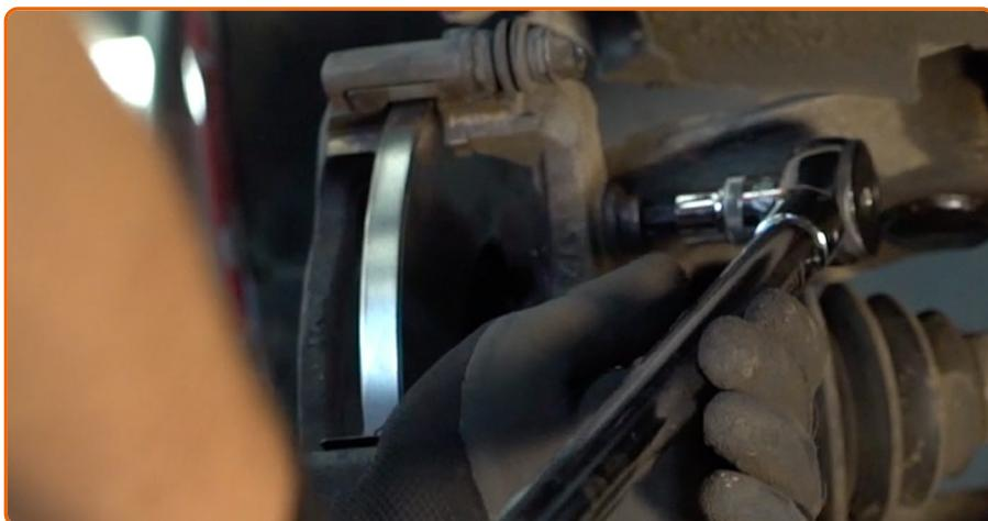
Apriete la fijación de la pinza del cáliber de freno. Utilice Torx T55. Utilice una llave dinamométrica. Apriételo a un par de 70 Nm.
