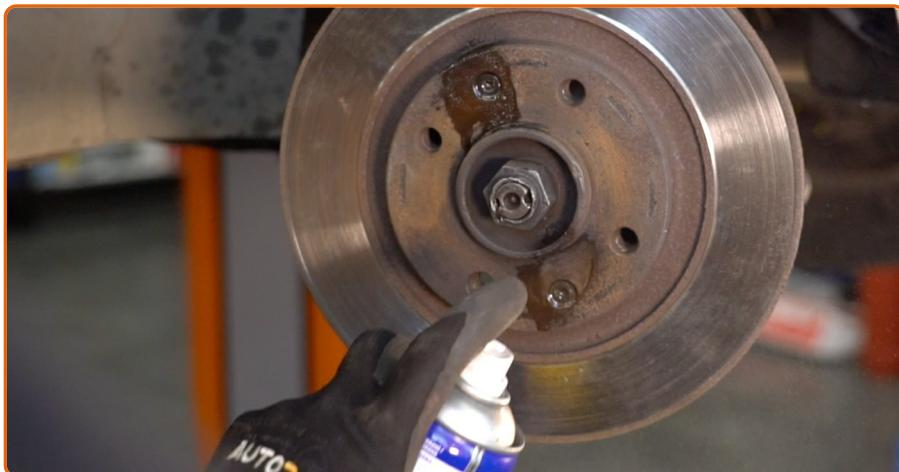
Limpie las sujeciones del disco de freno. Use un cepillo de alambre. Use el aerosol WD-40.
