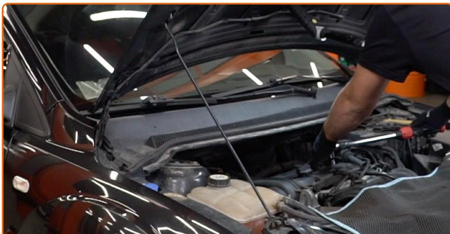
Atornille las bujías nuevas y apriételas. Use el vaso de bujía # 16. Utilice una llave dinamométrica. Apriételo a un par de 25 Nm.
