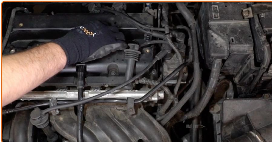
Instale las nuevas bujías en sus asientos de montaje.
