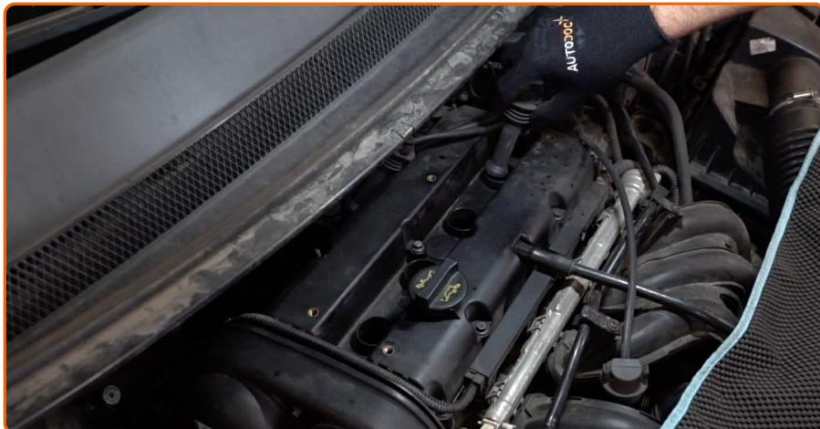
Instale los conectores del cable de bujía en los pozos de la bujía. Asegúrese de que escucha un sonido clic indicando que está bloqueado en su lugar.
