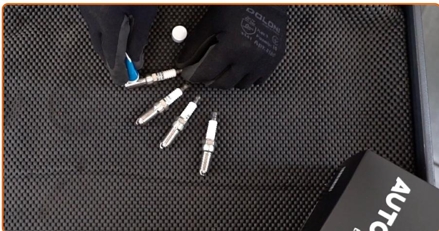
Aplique una capa fina de un lubricante antigripado especial de alta temperatura a las roscas de las nuevas bujías. Trate la superficie de los terminales de las nuevas bujías. Utilice una grasa de alta temperatura.
