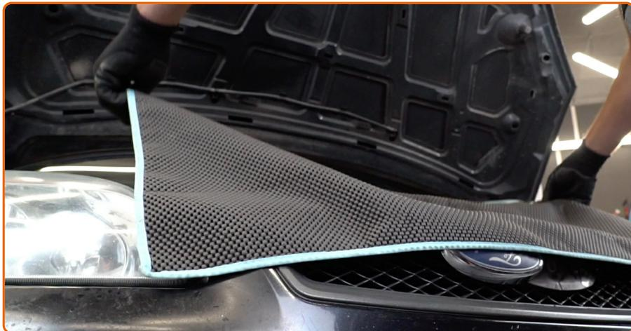
Utilice un protector de aletas para evitar daños en la pintura y en las partes de plástico del automóvil.
