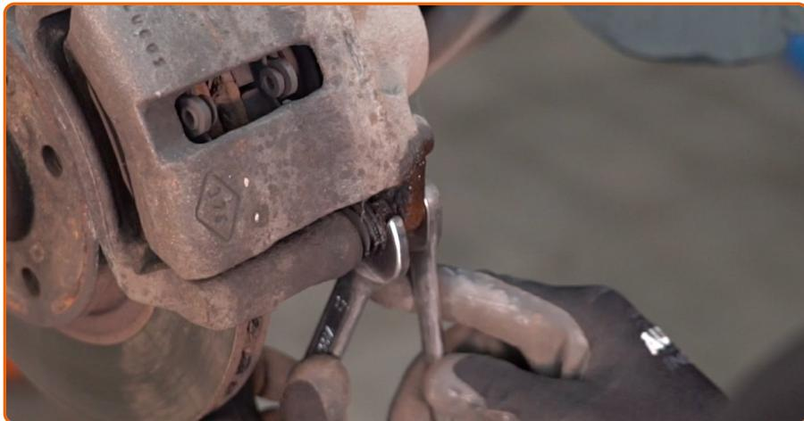
Destornille la fijación del cálibre de freno. Usa una llave mixta del n.º 13. Usa una llave mixta del n.º 17.
