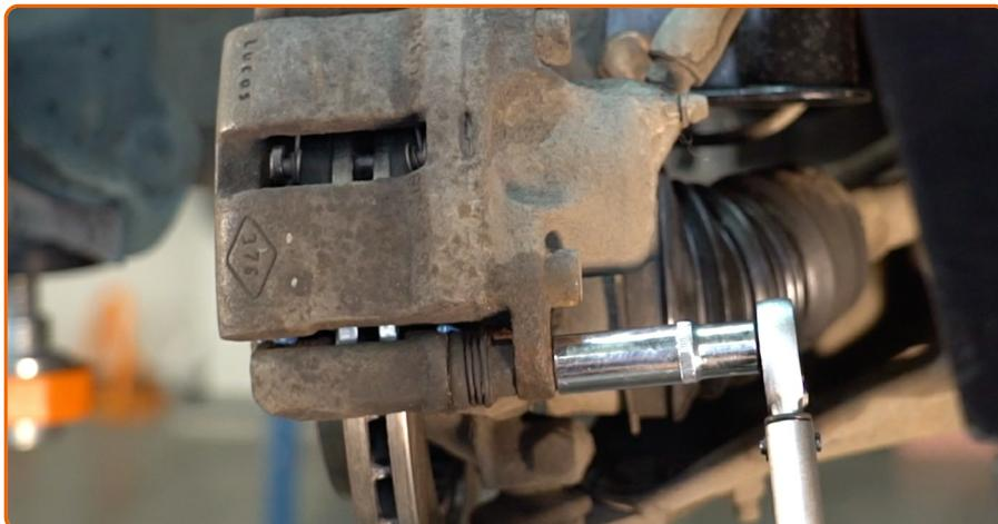
Establezcan el soporte de freno y lo fijen. Usa una llave mixta del n.º 13. Usa una llave mixta del n.º 17. Utilice una llave dinamométrica. Apriételo a un par de 35 Nm.
