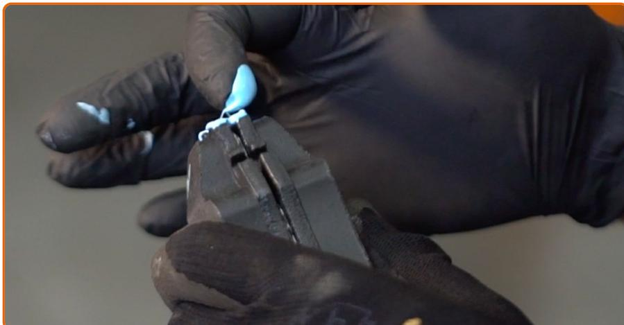
Trate las pastillas de freno en el área donde su superficie entra en contacto con el soporte de la pinza de freno. Use pasta antichirridos.
