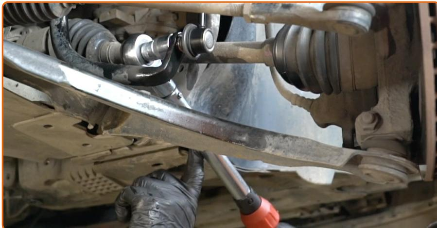
Apriete la sujeción que conecta la bieleta a la barra estabilizadora. Use un vaso de impacto del n.º 17. Utilice una llave dinamométrica. Apriételo a un par de 65 Nm.
