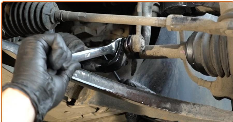
Desatornille la sujeción que conecta la bieleta a la barra estabilizadora. Usa una llave mixta del n.º 16. Use Vaso HEX No. H6. Utilice una llave de trinquete.
