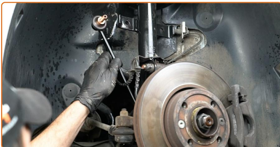
Instale la barra del estabilizador de estabilidad transversal.
