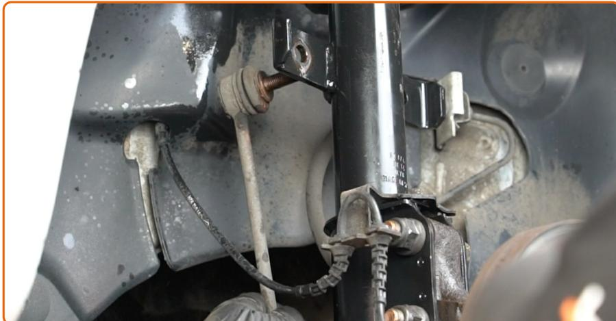
Retire el enlace estabilizador de estabilidad transversal.
