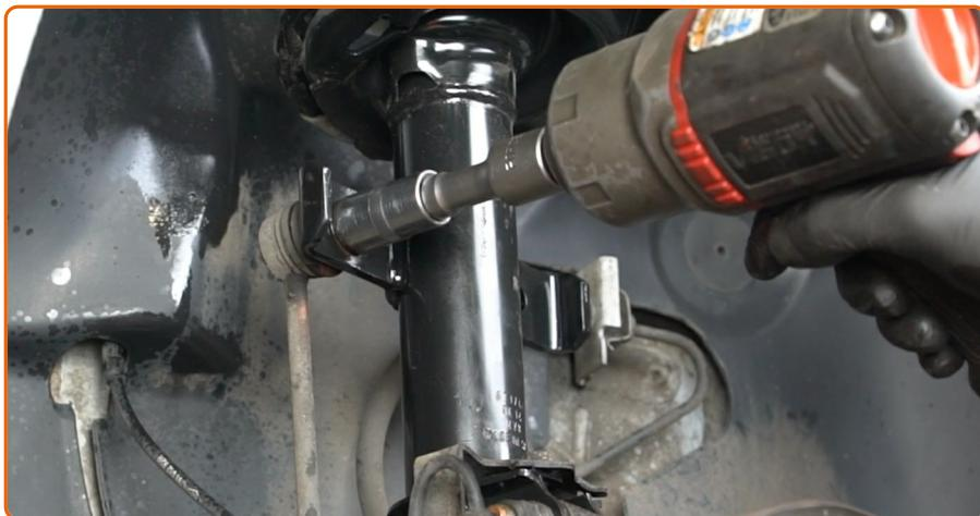
Desatornille la sujeción que conecta la bieleta de barra estabilizadora al amortiguador. Use un vaso de impacto del n.º 16. Utilice una llave de trinquete.
