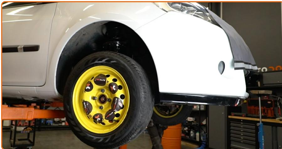
Baje el automóvil y, manteniendo el orden cruzado, apriete los pernos de fijación de las ruedas. Utilice una llave de impacto para llanta # 17. Utilice una llave dinamométrica. Apriételo a un par de 120 Nm.
