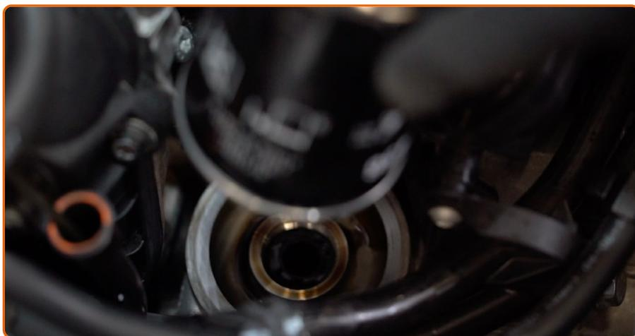
Atornille el filtro nuevo en su sitio. Apriételo a un par de torsión de 18 Nm. Utilice una llave dinamométrica. Utilice el vaso 76/14.
