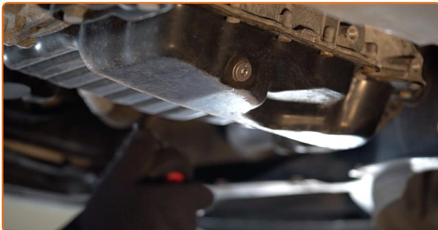
Destornille el tapón de desagüe. Utilice Torx T40. Utilice una llave de trinquete.
