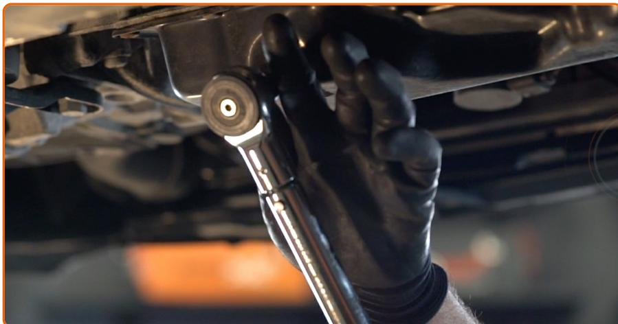
Atornille en el nuevo tapón de drenaje y apriételo. Utilice Torx T40. Utilice una llave dinamométrica. Apriételo a un par de 30 Nm.
