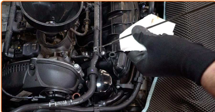
Verifique el nivel de aceite en 5 minutos después de parar el funcionamiento del motor, usando la tienta, y en caso necesario añada un poco más de aceite.
