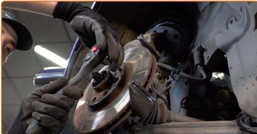
Destornille la fijación del disco de freno. Utilice Torx T30. Utilice una llave de trinquete.
