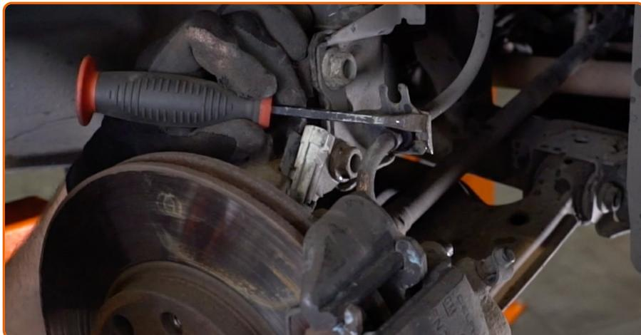
Retire la sujeción que une el latiguillo de freno al puntal amortiguador. Use una palanca.
