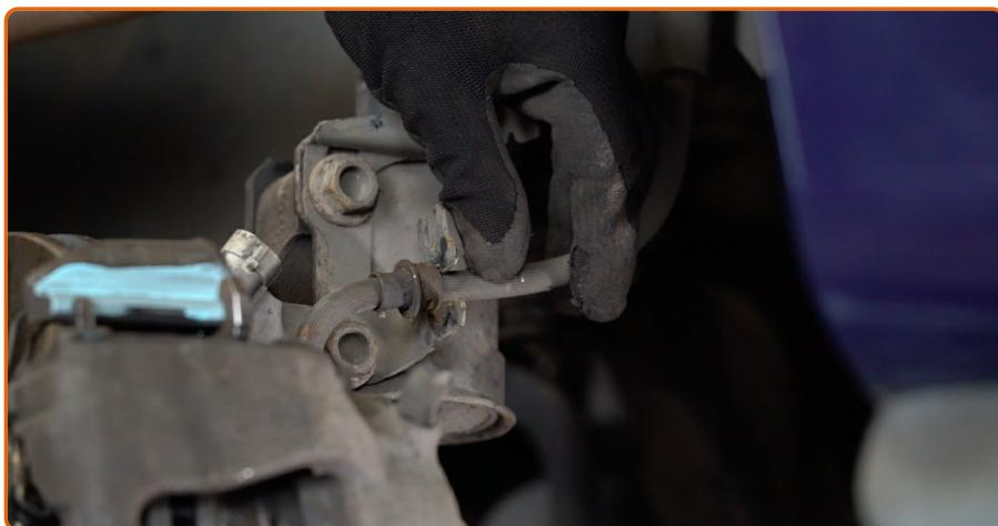
En la pata fije el latiguillo del sistema de freno.
