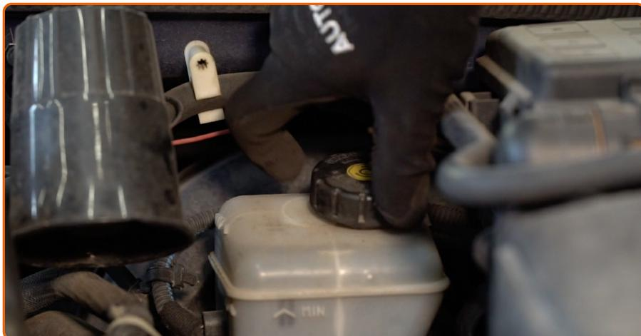
Apriete el tapón del depósito de líquido del freno. Cierre la capota.
