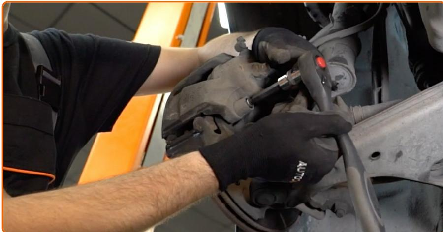
Destornille la fijación del cáliber de freno. Use Vaso HEX No. H7. Utilice una llave de trinquete.
