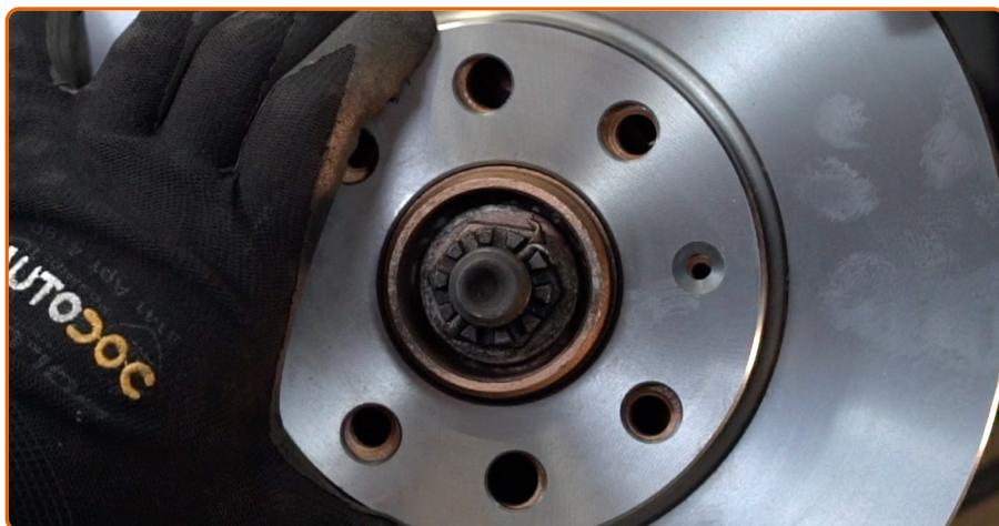
Apriete la fijación del disco de freno. Utilice Torx T30. Utilice una llave dinamométrica. Apriételo a un par de 9 Nm.
