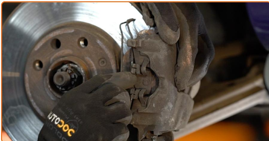
Tire a un lado del muelle de retención de la pinza de freno. Use una palanca.
