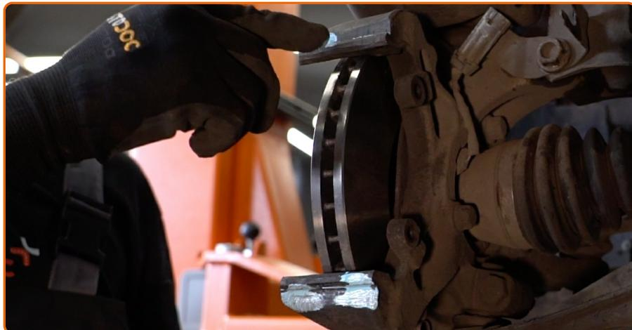
Trate el soporte de la pinza de freno donde entra en contacto con las pastillas de freno. Use pasta antichirridos.
