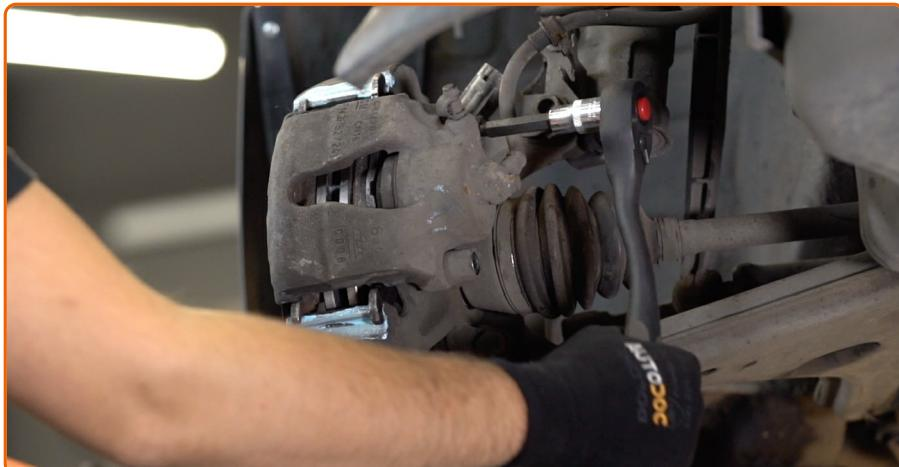
Apriete las sujetaciones de la pinza del freno. Use Vaso HEX No. H7. Utilice una llave dinamométrica. Apriételo a un par de 35 Nm.
