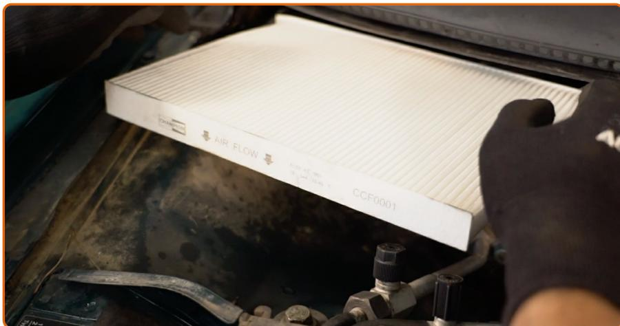
Saque de la carcasa del filtro el elemento filtrante de recambio.
