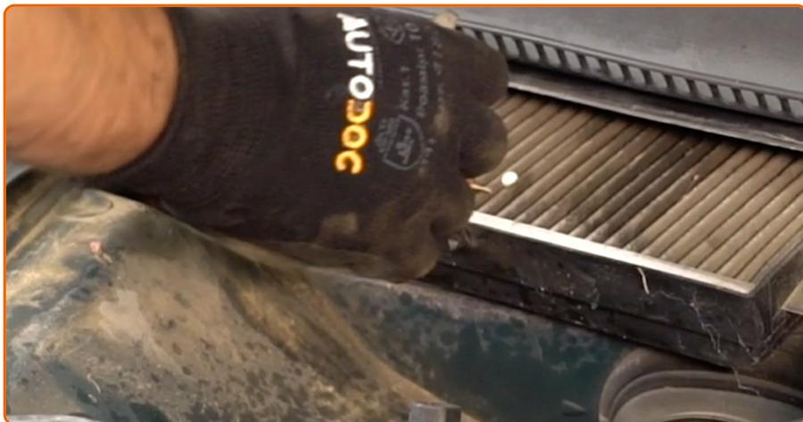
Inserte en la carcasa del filtro el nuevo elemento filtrante. Asegúrese de que el borde del filtro encaje firmemente en la carcasa.
