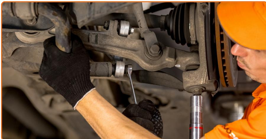
Apriete las fijaciones de la bieleta de la barra estabilizadora. Usa una llave mixta del n.º 16.
