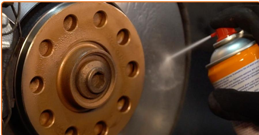
Limpie el asiento de montaje de la llanta de la rueda. Use un limpiador de frenos.
