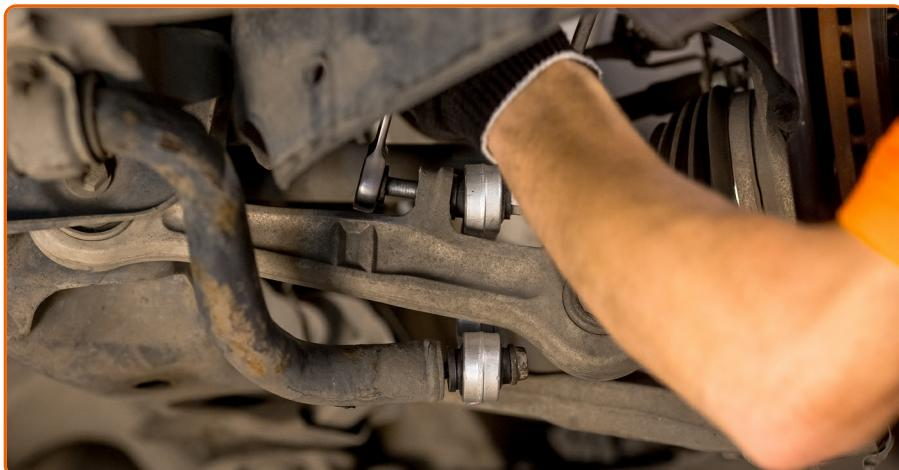
Apriete la sujeción que conecta la barra estabilizadora con el brazo de control. Usa una llave mixta del n.º 16. Utilice una llave dinamométrica. Apriételo a un par de 55 Nm.
