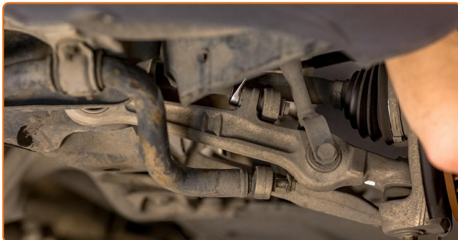
Desenrosque la sujeción que conecta la barra estabilizadora con el brazo de control. Usa una llave mixta del n.º 16.
