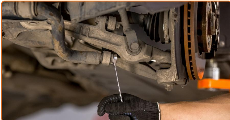
Desatornilla la sujeción que conecta la bieleta a la barra estabilizadora. Usa una llave mixta del n.º 16.
