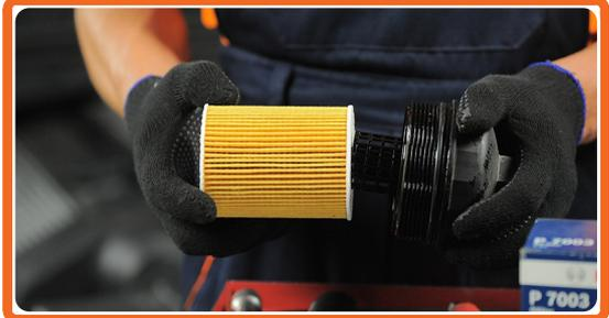
Inserte en la carcasa del filtro el nuevo elemento filtrante.
