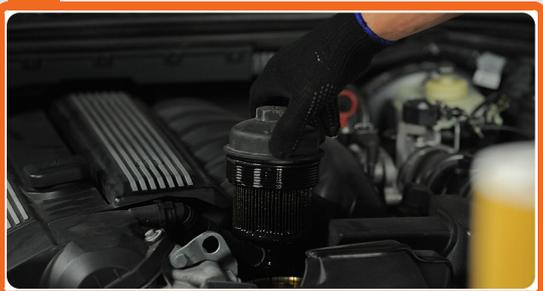
Destornille la tapa del cuerpo del filtro junto con el elemento filtrante antiguo.
