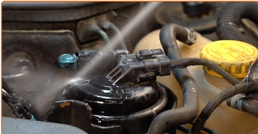
Limpie la carcasa del filtro de combustible y la cubierta. Utilice un spray de limpieza multiuso.
