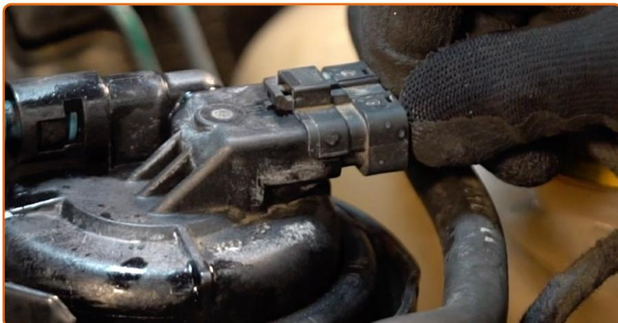
Conecte el conector del sensor de presión de combustible.
