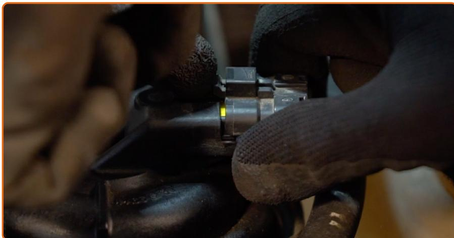
Desconecte el conector del sensor de presión de combustible.
