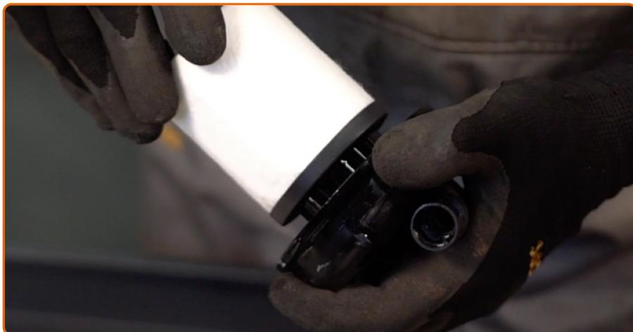
Inserte el filtro de combustible en el portador así que las marcas estén una en frente de la otra.
