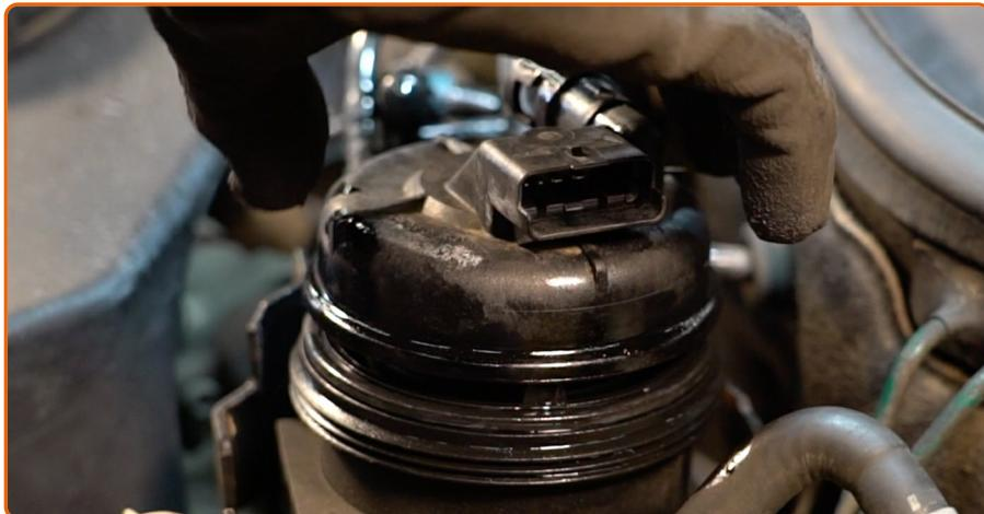
Instale y atornille la tapa de la carcasa del filtro de combustible.
