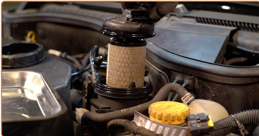
Destornille la tapa del cuerpo del filtro junto con el elemento filtrante antiguo.
