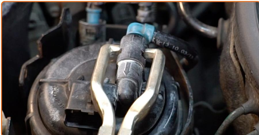
Apriete los clips y separe las líneas de suministro de combustible de la carcasa del filtro de aceite. Utilice alicates para conectores de tubos de combustible.
