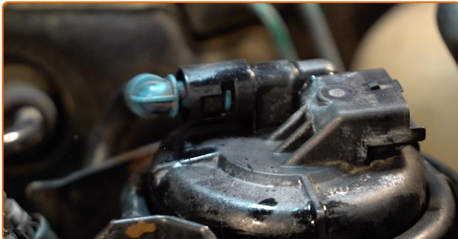
Conecte las líneas de admisión del combustible al filtro de combustible y cierre las grapas de fijación.
