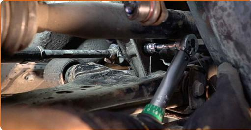
Sustitución: silentblock barra estabilizadora - Skoda Fabia 6Y5. AUTODOC recomienda:
