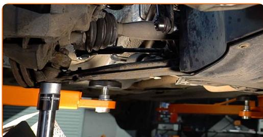
16 Instale los pernos de sujeción (2 piezas). Use una palanca.
