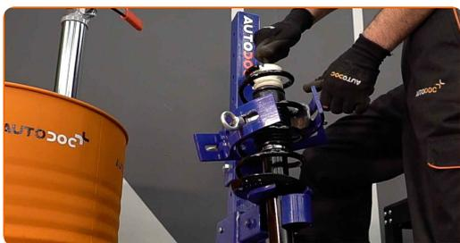
**38** Instale el soporte de montaje superior del puntal y el cojinete del soporte de montaje del puntal.
