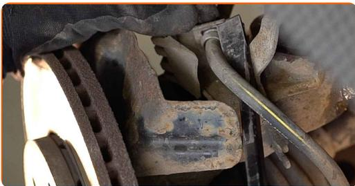
**15** Retire el perno de sujeción.
