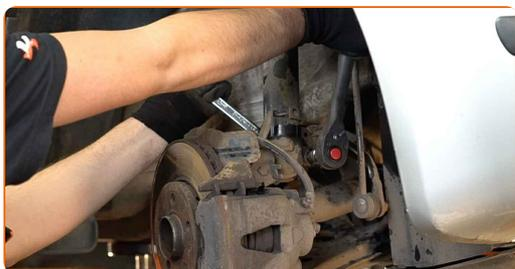
**14** Separe el latiguillo de freno del puntal amortiguador. Use una palanca.
