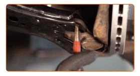
Apriete las sujeciones de la rótula. Use un vaso de impacto del n.º 13. Utilice una llave dinamométrica. Apriételo a un par de 20 Nm.+90°
