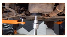
Retire el perno de sujeción. Use una palanca. Utilice un mazo de goma.
