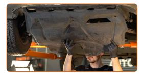
Atornille las sujeciones del aislante acústico inferior. Use un vaso de impacto del n.º 12. Utilice un destornillador Phillips.
