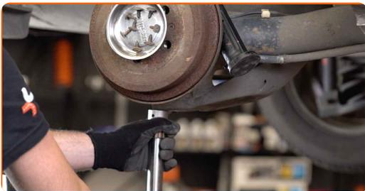
**9** Limpie las sujeciones del amortiguador. Use un cepillo de alambre. Use el aerosol WD-40.
