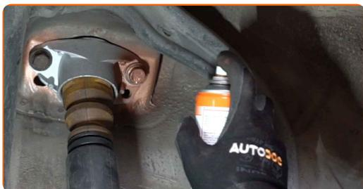
**27** Apriete la fijación inferior del amortiguador. Use un vaso de impacto del n.º 16. Use una llave mixta del n.º 16. Utilice una llave dinamométrica. Apriételo a un par de 40 Nm.+90°
