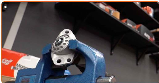
**20** Atornille la fijación superior de la varilla del amortiguador. Use una llave mixta del n.º 17. Use una llave ajustable. Utilice una llave dinamométrica. Apriételo a un par de 25 Nm.
