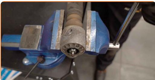
**15** Destornille la fijación de la varilla del amortiguador. Usa una llave mixta del n.º 17. Use una llave ajustable.
