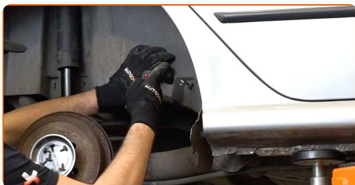
**31** Limpie el asiento de montaje de la llanta de la rueda. Use un cepillo de alambre. Trate la superficie de contacto. Use grasa de cobre.
