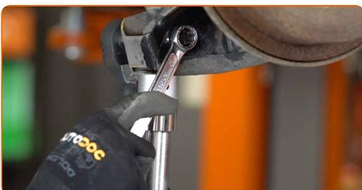
**11** Destornille la fijación superior del amortiguador. Use un vaso de impacto del n.º 16. Utilice una llave de trinquete.
