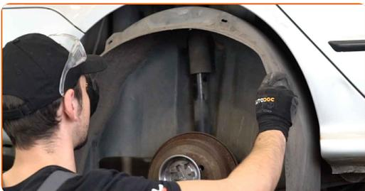
**8** Apuntale la barra trasera del puente. Utilice un gato de transmisión hidráulica.
