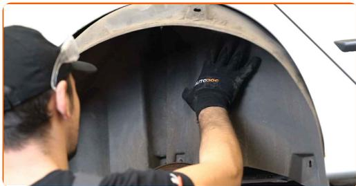
**30** Instale y apriete las sujeciones de la cubierta del paso de rueda. Utilice Torx T25.
