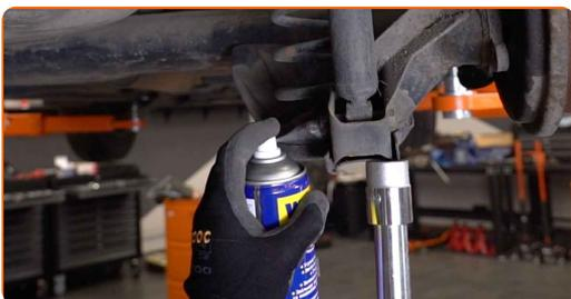
**10** Destornille la fijación inferior del amortiguador. Use un vaso de impacto del n.º 16. Usa una llave mixta del n.º 16. Utilice una llave de trinquete.
