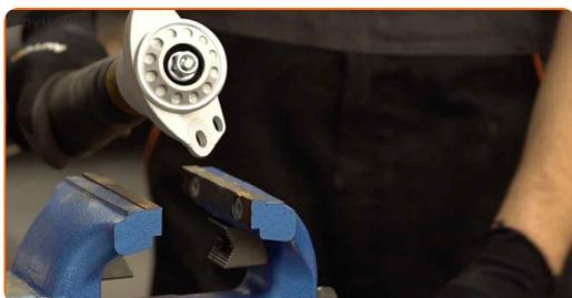
**22** Limpie los asientos de montaje del amortiguador. Use un cepillo de alambre. Use el aerosol WD-40.
