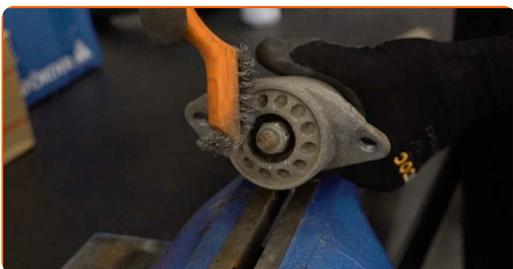
**14** Sujete el amortiguador en un tornillo de banco.
