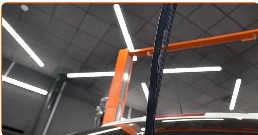
**5** Presione el clip de fijación. Retire la escobilla del brazo del limpiaparabrisas.
