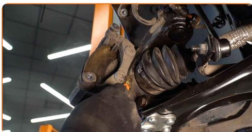
**15** Destornille la fijación de la pinza del cáliper de freno. Utilice Torx T55. Utilice una llave giramachos.
