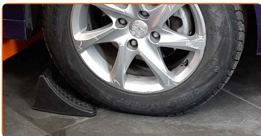
**5** Afloje los pernos de fijación de la rueda. Utilice una llave de impacto para llanta # 17.
