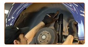
Instale y apriete las sujeciones de la cubierta del paso de rueda. Utilice Torx T20.
