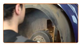
Desconecte la sujeción de la cubierta protectora de plástico del eje trasero.
