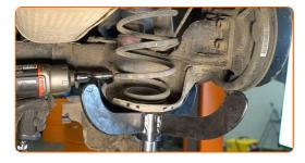
Retire el perno de sujeción.
