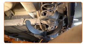
10.1 Limpie las sujeciones del amortiguador.
