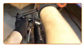
Apriete la fijación inferior del amortiguador. Use un vaso de impacto del n.º E18. Utilice una llave dinamométrica. Apriételo a un par de 100 Nm.
