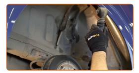
Trate los asientos de montaje del amortiguador. Use un cepillo de alambre. Use el aerosol WD-40.
