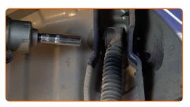
Retire el perno de sujeción.
