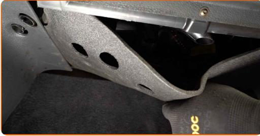
4 Levante, suelte cuidadosamente de las sujeciones y retire el panel de guarnecido lateral en el lado del pasajero.
