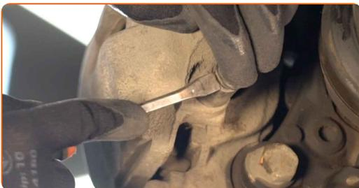
**8** Destornille la fijación del cáliper de freno. Use Vaso HEX No. H7. Utilice una llave de trinquete.
