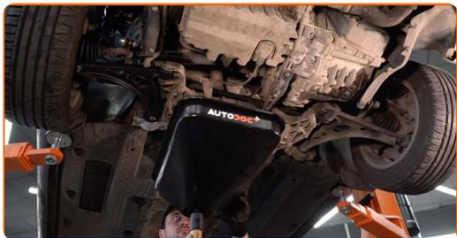
**12** Limpie el área del orificio de drenaje de la bandeja de aceite. Use un cepillo de alambre. Use el aerosol WD-40.
