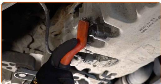
**13** Destornille el tapón de desagüe. Usa una llave mixta del n.º 19. Utilice una llave de trinquete.
