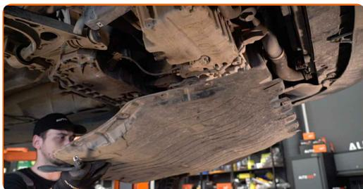
**11** Coloque un contenedor para el aceite de desecho con al menos 5 l de capacidad debajo del orificio de drenaje.
