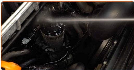
**5** Destornille la tapa del cuerpo del filtro junto con el elemento filtrante antiguo. Use un vaso de impacto del n.º 32. Utilice una llave de trinquete.
