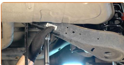
**20** Instale el perno de sujeción.
