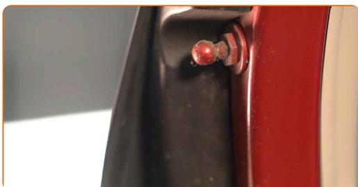
**6** Limpie los asientos de montaje del resorte amortiguador del maletero.
