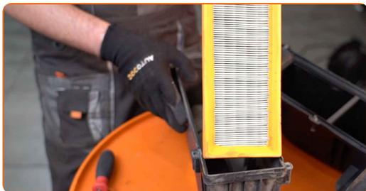
**11** Limpie la cubierta y la carcasa del filtro de aire.
