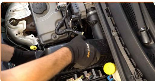
**17** Introduzca los pernos de fijación del cuerpo del filtro. Use un vaso de impacto del n.º 10. Utilice una llave de trinquete.
