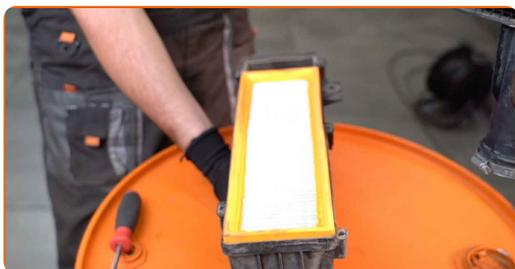
**10** Saque de la carcasa del filtro el elemento filtrante de recambio.
