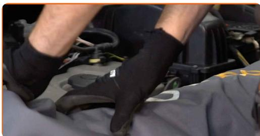
**3** Suelte la abrazadera del manguito de admisión de aire. Use un vaso de impacto del n.º 7. Utilice una llave de trinquete.
