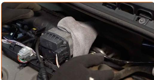
**8** Afloje los tornillos de sujeción de la cubierta del filtro de aire. Utilice un destornillador Phillips.
