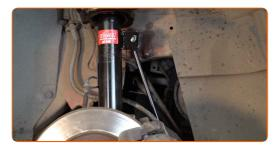
Apriete la sujeción que conecta la bieleta a la barra estabilizadora. Use un vaso de impacto del n.º 17. Utilice una llave dinamométrica. Apriételo a un par de 35 Nm.
