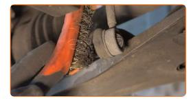
Desatornille la sujeción que conecta la bieleta a la barra estabilizadora. Usa una llave mixta del n.º 17. Utilice Torx T30. Utilice una llave de trinquete.
