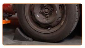
Afloje los pernos de fijación de la rueda. Utilice una llave de impacto para llanta # 17.
