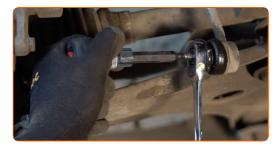
Retire el enlace estabilizador de estabilidad transversal.
