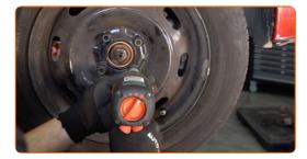
Baje el automóvil y, manteniendo el orden cruzado, apriete los pernos de fijación de las ruedas. Utilice una llave de impacto para llanta # 17. Utilice una llave dinamométrica. Apriételo a un par de 90 Nm.
