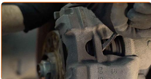
**10** Limpie las sujeciones de la pinza del freno. Use un cepillo de alambre. Use el aerosol WD-40.
