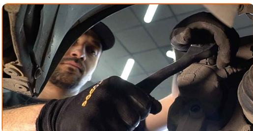
**12** Separe el muelle de retención de la pinza de freno. Use una palanca.
