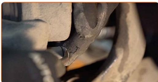
**8** Desconecte la clavija del sensor de desgaste de las pastillas de freno.
