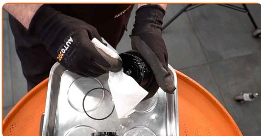
**15** Instale una nueva junta tórica en el asiento de montaje de la cubierta del filtro.
