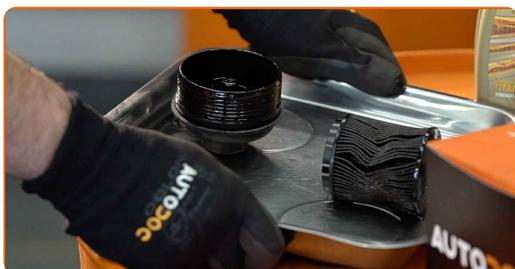
**13** Retire la junta tórica de la tapa del filtro de aceite. Utilice un destornillador plano.
