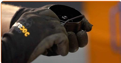
**16** Instale el nuevo filtro de aceite en el asiento de montaje de la cubierta del filtro.
