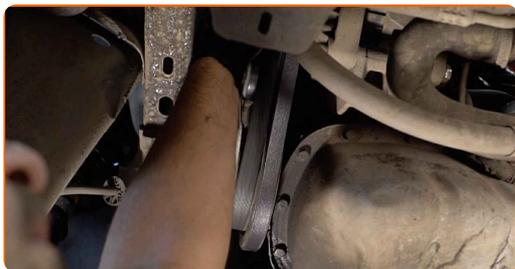
**16** Vuelva a colocar la polea tensora en su posición inicial. Use una llave mixta del n.º 21.
