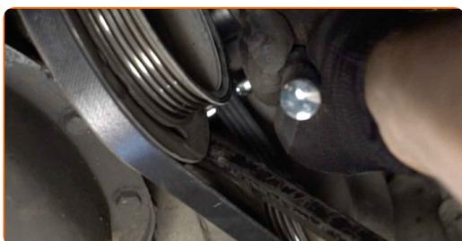
**14** Atornille la sujeción inferior del alternador. Use un vaso de impacto del n.º 13. Use un vaso de impacto del n.º 16. Utilice una llave de trinquete.
