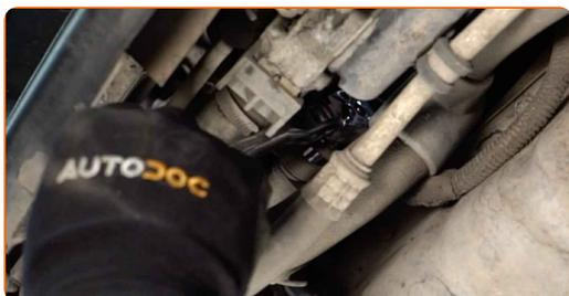
**15** Instale la correa del compresor de aire acondicionado.
