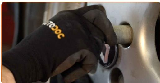
**27** Baje el automóvil y, manteniendo el orden cruzado, apriete los pernos de fijación de las ruedas. Utilice una llave dinamométrica. Apriételo a un par de 90 Nm.
