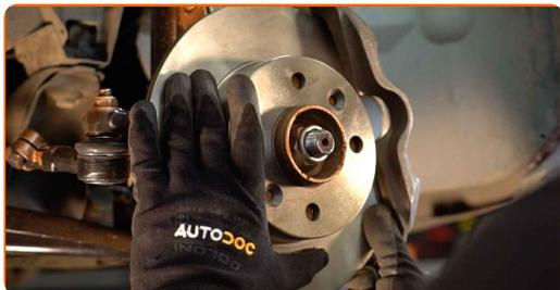
**19** Apriete la fijación del disco de freno. Utilice Torx T30. Utilice una llave dinamométrica. Apriételo a un par de 15 Nm.
