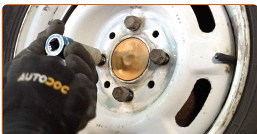
**23** Baje el automóvil y, manteniendo el orden cruzado, apriete los pernos de fijación de las ruedas. Utilice una llave dinamométrica. Apriételo a un par de 90 Nm.
