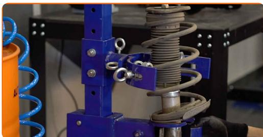
28 Limpie la barra del amortiguador. Use el aerosol WD-40.
