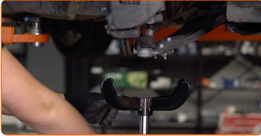
22 Suelte la sujeción inferior que conecta el puntal amortiguador a la mangueta de dirección. Utilice un vaso de impacto especial para extraer el amortiguador. Utilice un martillo. Utilice un cincel de metal plano.
