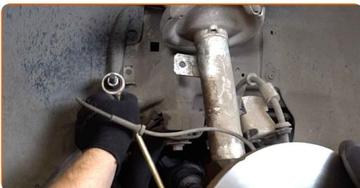
**20** Desatornille la sujeción inferior que conecta el puntal amortiguador a la mangueta de dirección. Use un vaso de impacto del n.º 18. Utilice una llave de trinquete. Utilice una llave giramachos.
