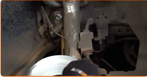
**18** Limpie las fijaciones que conectan la bieleta de la barra estabilizadora al puntal amortiguador, y aquellos que conectan el puntal del amortiguador a la mangueta de rueda. Use un cepillo de alambre. Use el aerosol WD-40.
