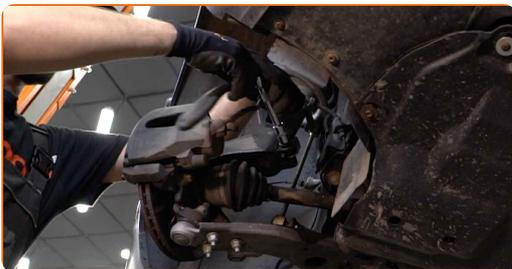
21 Sostenga el muñón de dirección. Utilice un gato de transmisión hidráulica.
