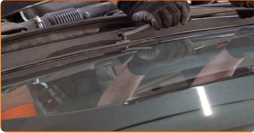
**56** Apriete las fijaciones de los brazos del limpiaparabrisas. Use un vaso de impacto del n.º 15. Utilice una llave dinamométrica. Apriételo a un par de 10 Nm.
