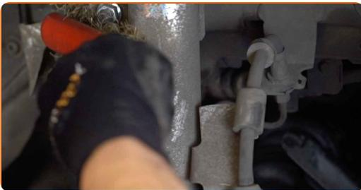
19 Destornille la tuerca y quite la barra del estabilizador desde la pata amortiguadora. Use un vaso de impacto del n.º 15. Utilice una llave de trinquete.
