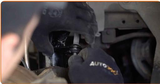
46 Fije el enlace estabilizador de el soporte de amortiguador. Use un vaso de impacto del n.º 15. Utilice una llave dinamométrica. Apriételo a un par de 48 Nm.
