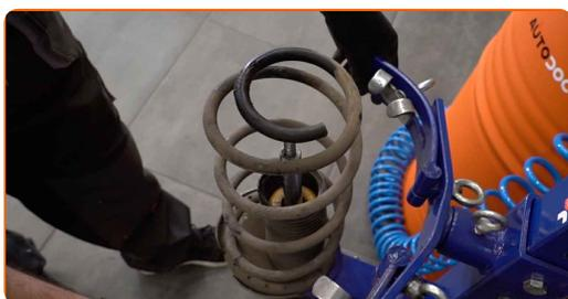
**33** Instale un nuevo soporte de la pata amortiguadora y apriétela.
