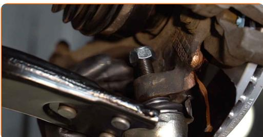
**21** Instale el tornillo de sujeción trasero del brazo.
