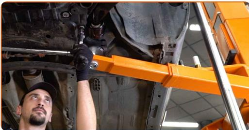
**25** Apriete la tuerca de fijación del soporte esférico. Usa una llave mixta del n.º 22. Utilice una llave dinamométrica. Apriételo a un par de 70 Nm.
