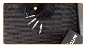
Instale las nuevas bujías en sus asientos de montaje.
