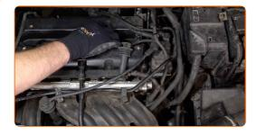
Atornille las buujías nuevas y apriételas. Use el vaso de bujía # 16. Utilice una llave dinamométrica. Apriételo a un par de 15 Nm.
