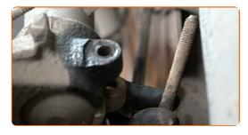
Desenrosque las sujeciones que conectan la rótula al brazo de control. Usa una llave mixta del n.º 17. Use un vaso de impacto del n.º 16. Utilice una llave de trinquete.
