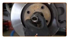
Limpie las sujeciones que conectan el puntal amortiguador a la mangueta de dirección.
