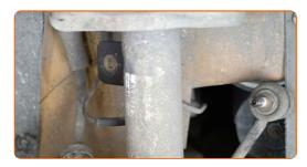
Limpie la sujeción del soporte que conecta el latiguillo de freno al puntal de suspensión. Use un cepillo de alambre. Use el aerosol WD-40.
