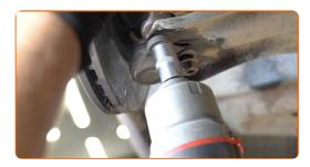
Apriete las sujeciones que conectan la rótula al brazo de control. Use un vaso de impacto del n.º 16. Utilice una llave dinamométrica. Apriételo a un par de 65 Nm.
