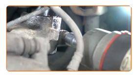
Limpie las ranuras de la junta homocinética del eje de transmisión. Use un cepillo de alambre. Use el aerosol WD-40.
