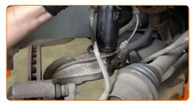
57 Instale el perno de sujeción.
