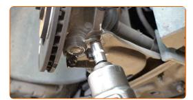
Desconecte el soporte esférico del brazo. Use una palanca.
