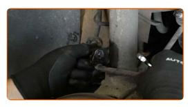
Desconecte el cableado del captador ABS. Use una palanca.
