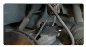
Destornille la fijación superior de la cazoleta de la pata amortiguadora.
