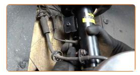
Limpie los asientos de montaje de la bieleta de barra estabilizadora. Use un cepillo de alambre. Use el aerosol WD-40.
