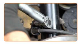
72 Conecte los cables del captador ABS.
