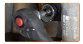
Retire el enlace estabilizador de estabilidad transversal.
