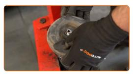
Apriete la tuerca de la varilla de la pata amortiguadora. Use un vaso de impacto del n.º 19. Use Vaso HEX No. H6. Utilice una llave dinamométrica. Apriételo a un par de 75 Nm.
