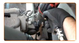
Retire el perno de sujeción.
