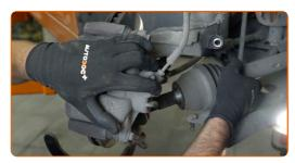
Desconecte el muñón de dirección de la pata amortiguadora. Utilice un martillo.
