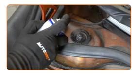
Afloje la sujeción superior del soporte del amortiguador. Usa una llave mixta del n.º 21. Use Vaso HEX No. H7. Utilice una llave de trinquete.
