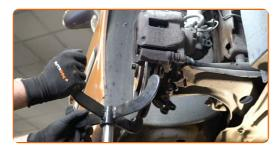
Separe el eje de transmisión de la mangueta de dirección. Use un punzón. Utilice un martillo.
