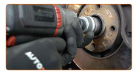
Apriete la tuerca del eje de transmisión. Use un vaso de impacto del n.º 35. Utilice una llave dinamométrica. Apriételo a un par de 245 Nm.
