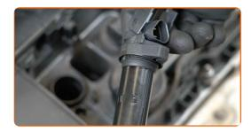
Trate el conector de la bobina de encendido con spray para electrónica. El spray protegerá los contactos eléctricos de la corrosión, oxidación, y reducirá la resistencia de contacto.
