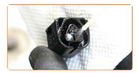
Enchufe el conector de la bobina de encendido. Asegúrese de que escucha un sonido clic indicando que está bloqueado en su lugar.
