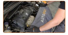
Desatornille la sujeción de la cubierta del motor. Use un vaso de impacto del n.º 8. Utilice una llave de trinquete.
