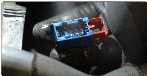
**13** Una el conector del sensor de oxígeno.
