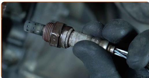
**7** Limpie el asiento de montaje del sensor de oxígeno. Use el aerosol WD-40.
