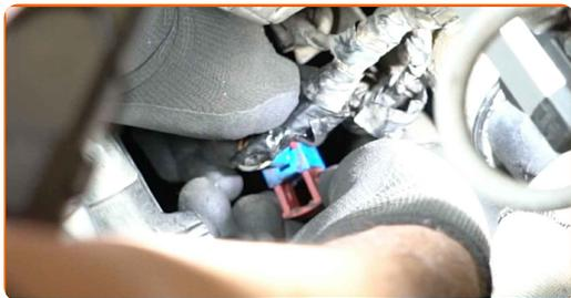
**4** Limpie la sujeción del sensor de oxígeno. Use un cepillo de alambre. Use el aerosol WD-40.
