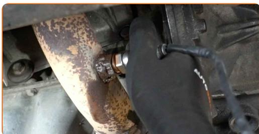
**11** Apriete la sujeción del sensor de oxígeno. Usa una llave mixta del n.º 22. Utilice una llave dinamométrica. Apriételo a un par de 47 Nm.
