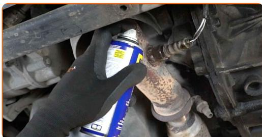
**5** Desenrosque la sujeción del sensor de oxígeno. Utilice un vaso para sensor de oxígeno de 22 mm. Utilice una llave de trinquete.
