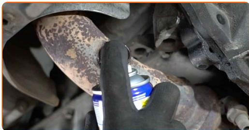
**8** Corte la rosca para el nuevo sensor de oxígeno. Utilice un macho de roscar. Utilice una llave de trinquete.
