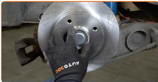
**28** Limpie los asientos de montaje de la pinza de freno y su soporte. Use un cepillo de alambre. Use el aerosol WD-40.
