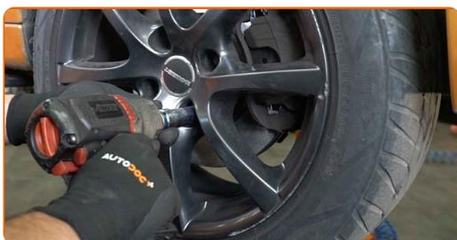
**24** Baje el automóvil y, manteniendo el orden cruzado, apriete los pernos de fijación de las ruedas. Utilice una llave de impacto para llanta # 17. Utilice una llave dinamométrica. Apriételo a un par de 100 Nm.
