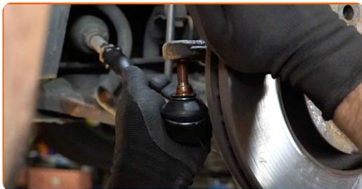
**15** Atornille la tuerca de sujeción que conecta el extremo de la barra de acoplamiento a la mangueta de dirección. Use un vaso de impacto del n.º 17. Utilice una llave de trinquete.
