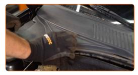
Instale las sujeciones de la rejilla de plástico del capó del limpiaparabrisas.
