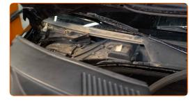
Limpie la carcasa y la cubierta del filtro de cabina. Utilice un spray de limpieza multiuso.
