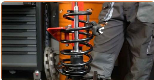
**44** Instale el soporte, el fuelle y el tope en el amortiguador.
