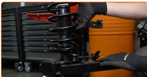
**49** Trate el asiento de montaje del puntal amortiguador en la mangueta de dirección. Use un cepillo de alambre. Use el aerosol WD-40.
