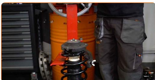
**47** Trate la varilla del amortiguador. Use grasa de cobre.
