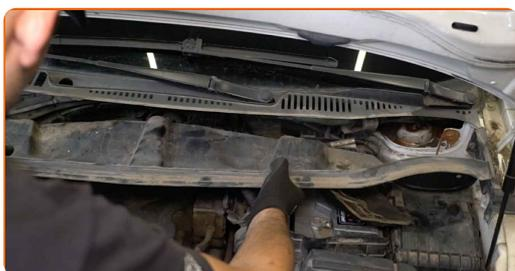
**81** Atornille las sujeciones de la bandeja del limpiaparabrisas. Use un vaso de impacto del n.º 10. Utilice una llave dinamométrica. Apriételo a un par de 4 Nm.
