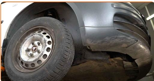
**75** Apriete el perno que conecta el eje de transmisión al cubo de la rueda. Use un vaso de impacto del n.º 27. Utilice una llave dinamométrica. Apriételo a un par de 200 Nm.+180°
