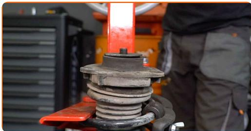
**36** Trate la varilla del amortiguador. Use un cepillo de alambre. Use el aerosol WD-40.
