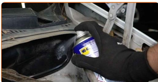
**5** Desatornille las sujeciones de la bandeja del limpiaparabrisas. Use un vaso de impacto del n.º 10. Utilice una llave de trinquete.
