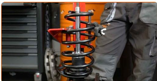
**46** Instale la cazoleta, el guardapolvos y el tope en el amortiguador nuevo.
