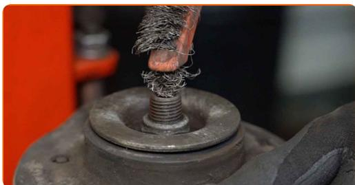
**37** Destornille la tuerca de la varilla de la pata amortiguadora. Use un vaso de impacto del n.º 21. Use Vaso HEX No. H6. Utilice una llave de trinquete.
