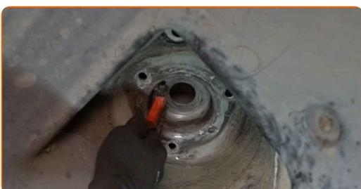
**52** Instale la pata amortiguadora en el arco de la rueda.
