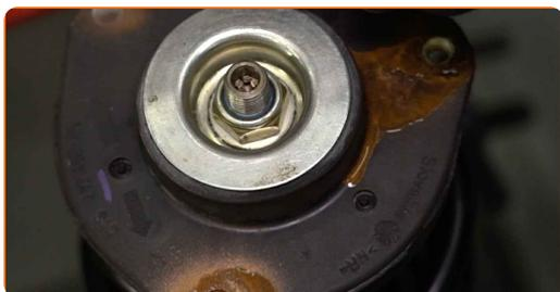
**50** Retire el puntal amortiguador que está montado.
