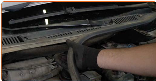
**4** Limpie las sujeciones de la cubierta de la rejilla del limpiaparabrisas. Use un cepillo de alambre. Use el aerosol WD-40.
