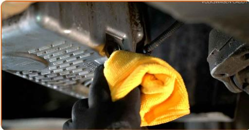
**12** Atornille en el nuevo tapón de drenaje y apriételo. Utilice un vaso de impacto n° 19 y o una llave de estrella n° 19. Utilice una llave dinamométrica. Apriételo a un par de 30 Nm.
