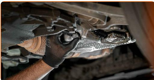
**13** Vuelva a instalar la cubierta inferior del cárter de aceite. Apriete los sujetadores de la cubierta inferior del cárter de aceite. Utilice Torx T25.
