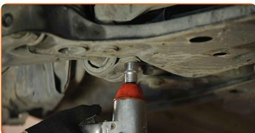
**17** Retire la sujeción trasera del brazo de control.
