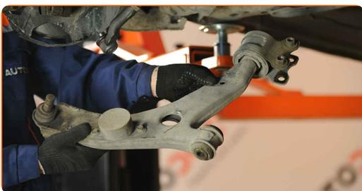
**19** Destornille las fijaciones y quite el tope de la palanca inferior de la suspensión independiente delantera. Use un vaso de impacto del n.º 12. Utilice una llave de trinquete.
