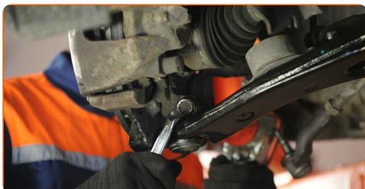
**30** Conecte la punta de la barra de dirección al muñón de dirección.
