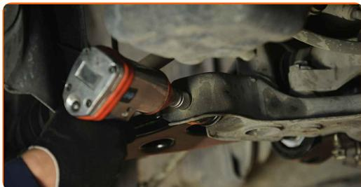
**26** Apriete la sujeción trasera del brazo de control. Use un vaso de impacto del n.º 18. Utilice una llave dinamométrica. Apriételo a un par de 86 Nm.
