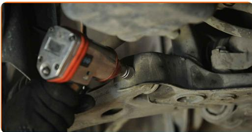
**15** Retire la sujeción delantera del brazo de control.
