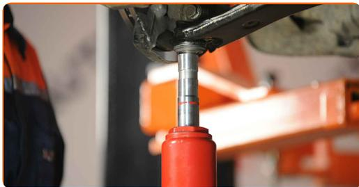
**33** Apriete la sujeción delantera que conecta el brazo de control al subchasis. Use un vaso de impacto del n.º 18. Utilice una llave dinamométrica. Apriételo a un par de 130 Nm.
