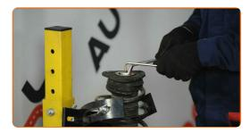
Quite el apoyo superior de la pata. Utilice un destornillador plano.
