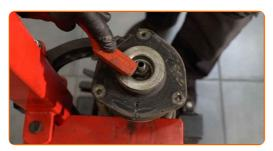
Destornille la tuerca de la varilla de la pata amortiguadora. Usa una llave mixta del n.º 19. Use Vaso HEX No. H6. Utilice una llave de trinquete.
