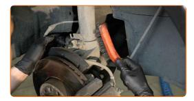
Desatornille la sujeción inferior que conecta el puntal amortiguador a la mangueta de dirección. Use un vaso de impacto del n.º 17. Utilice una llave de trinquete.
