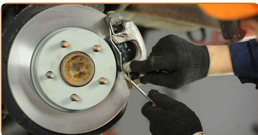
**26** Trate la superficie donde el disco del freno entra en contacto con la llanta de la rueda. Use grasa de cobre.
