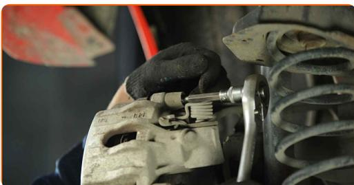
**10** Saque las guías desde el soporte de freno. Utilice un destornillador plano.
