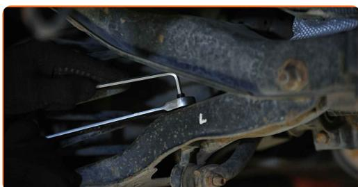
**14** Retire el perno de sujeción.
