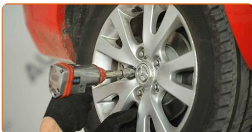
**34** Baje el automóvil y, manteniendo el orden cruzado, apriete los pernos de fijación de las ruedas. Utilice una llave de impacto para llanta # 19. Utilice una llave dinamométrica. Apriételo a un par de 118 Nm.
