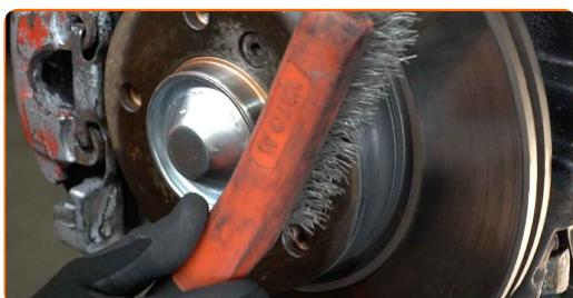
**50** Trate la superficie donde el disco del freno entra en contacto con la llanta de la rueda. Use grasa de cobre.
