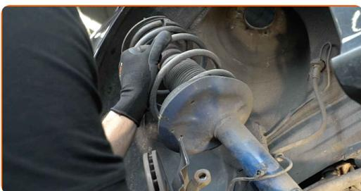
**19** Instale la pata amortiguadora en el mecanismo para apretar los resortes.
