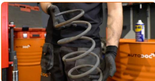
**27** Retire el amortiguador viejo del compresor de muelles hidráulico.
