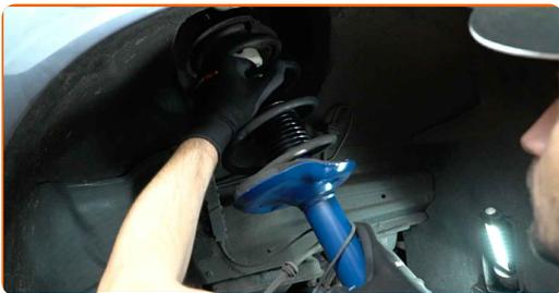
**40** Fije las sujeciones superiores del puntal amortiguador. No lo apriete.
