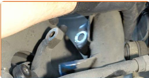
**17** Desatornille las sujeciones superiores del amortiguador.
