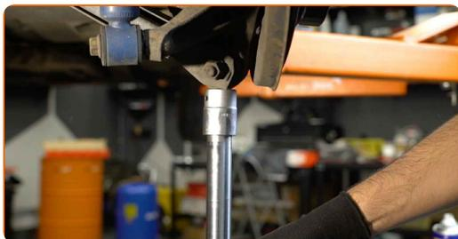
**27** Apriete la sujeción que conecta la barra estabilizadora con el brazo de control. Use un vaso de impacto del n.º 13. Utilice una llave dinamométrica. Apriételo a un par de 27 Nm.
