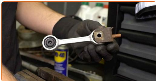
**19** Instale el perno de sujeción.
