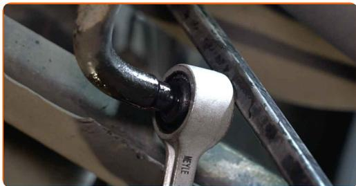
**24** Vuelva a instalar la barra estabilizadora en su asiento de montaje.
