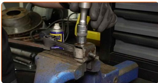
**14** Retire el perno de sujeción.
