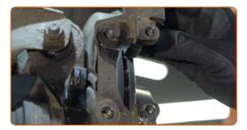
Limpie la sujeción del disco de freno. Use un cepillo de alambre. Use el aerosol WD-40.
