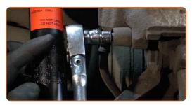
Separe el muelle de retención de la pinza de freno. Use una palanca. Utilice un destornillador plano.
