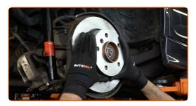
Apriete la fijación del disco de freno. Use Vaso HEX No. H6. Utilice una llave dinamométrica. Apriételo a un par de 9 Nm.
