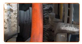
Destornille la fijación de la pinza del cáliper de freno. Use un vaso de impacto del n.º 16. Utilice una llave giramachos.
