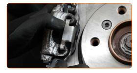
Apriete las sujeciones de la pinza del freno. Use Vaso HEX No. H7. Utilice una llave dinamométrica. Apriételo a un par de 30 Nm.
